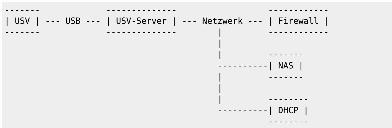
Da die USV nur einen USB-Anschluss hat, muss man einen Server aufsetzen. Von diesem aus kann man den USV-Status im Netzwerk verteilen. Für diesen Job ist ein Raspberry wie gemacht.
